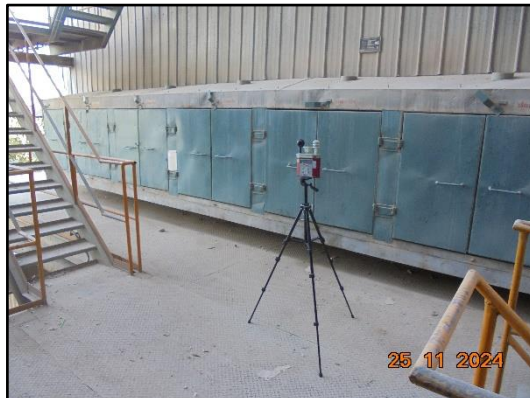
ภาพที่ 3.45 การตรวจวัดความร้อนในสถานที่ ทำงานบริเวณ PH Boiler ชั้น 2
