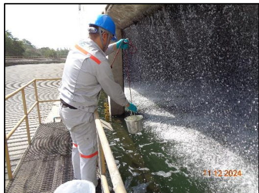
ภาพที่ 3.23 การตรวจวัดคุณภาพน้ำบริเวณ Cooling Tower
