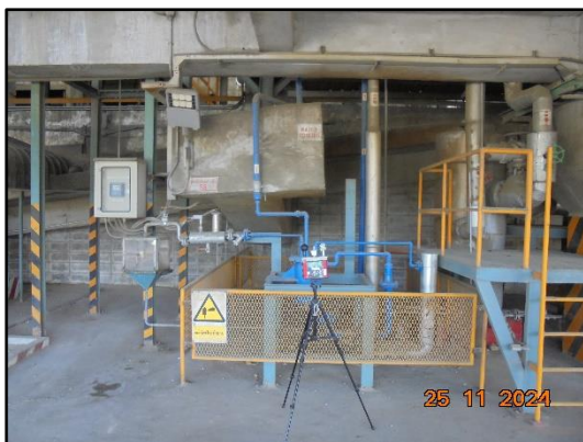
ภาพที่ 3.46 การตรวจวัดความร้อนในสถานที่ ทำงานบริเวณ AQC Boiler
