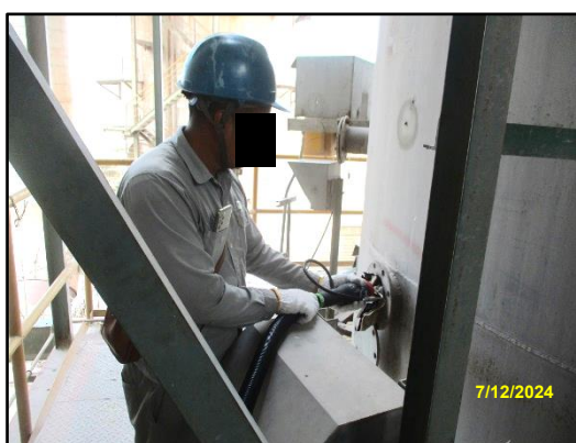
ภาพที่ 3.7 การตรวจวัด TOC จากปล่องหม้อเผา
